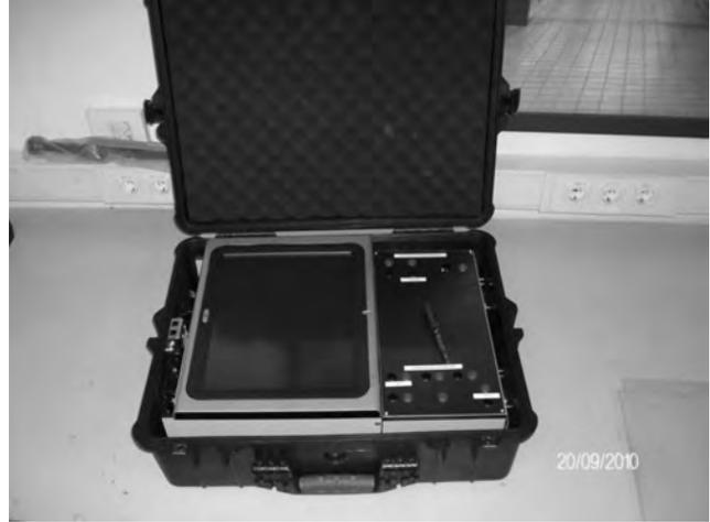
Fig. 6. Equipo montado en la maleta portátil, donde se aprecia el PC industrial de pantalla táctil
